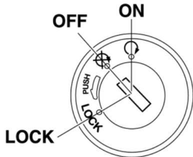
A chave de ignição/trava do guidão controla os sistemas de ignição e iluminação, e é utilizado para travar o guidão. As diversas posições estão descritas a seguir.
