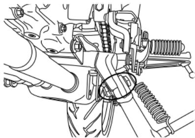
O funcionamento do cavalete lateral deve ser verificado antes de cada condução, e a articulação do cavalete lateral e superfícies de contato metal com metal devem ser lubrificadas, se necessário.
