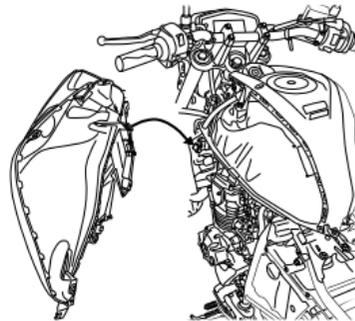
1. Coloque a carenagem em sua posição original e então instale os parafusos e fixadores rápidos.
