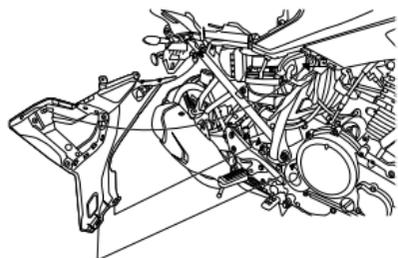
1. Coloque o painel em sua posição original, e então instale os parafusos e fixadores.
