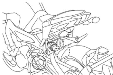
As articulações da balança devem ser lubrificadas por um concessionário Yamaha nos intervalos especificados na tabela de manutenção e lubrificação periódica.
