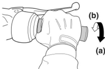
A velocidade pode ser ajustada abrindo e fechando o acelerador. Para aumentar a velocidade, gire o acelerador na direção (a). Para reduzir a velocidade, gire o acelerador na direção (b).
