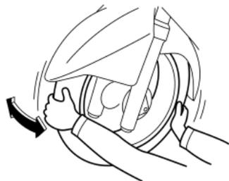
Os rolamentos da roda dianteira e traseira devem ser verificados nos intervalos da tabela de manutenção e lubrificação periódica. Se existir folga no cubo da roda dianteira ou traseira, ou se a roda não girar suavemente, solicite a um concessionário Yamaha que verifique os rolamentos da roda.
