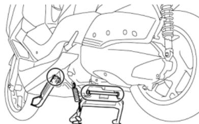
O funcionamento do cavalete central e lateral deve ser verificado antes de cada condução e as articulações e superfícies de contato metal com metal devem ser lubrificadas, se necessário.
